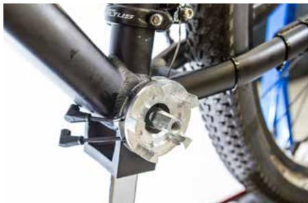
Der Motor wird auf der linken Seite des Rahmens montiert. Stecken Sie ihn zunächst nur leicht auf dem festzustellen, ob die Kabel von Raddrehzahlsensor und Messtretlager an der richtigen Stelle sitzen, damit sie am Motor angesteckt werden können. Dazu müssen die Nuten der Drehmomentaufnahme, in denen die Kabel fixiert sind, mit den Nuten im Motor fluchten.
