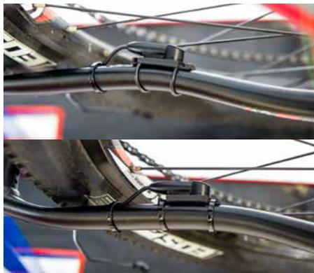
Als Gegenstück zum Sensor müssen Sie nun den Magneten an einer Speiche befestigen und ihn entsprechend zum Sensor ausrichten.
